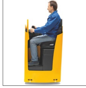
ESE 220/320'de yükseklik ayarı yapılabilen zemin plakasına sahip konforlu oturma pozisyonu
